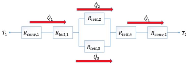
$$R_{\text{tot}} = R_{\text{conv},1} + R_{\text{leit},1} + \frac{R_{\text{leit},2} \cdot R_{\text{leit},3}}{R_{\text{leit},2} + R_{\text{leit},3}} + R_{\text{leit},4} + R_{\text{conv},2}$$
