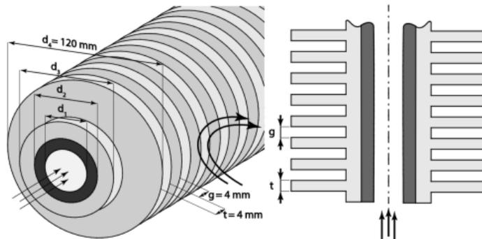
Die Lösung für kreisförmige Rippen brauchen Sie nicht zu berechnen; nehmen Sie stattdessen einen Rippenwirkungsgrad  $\eta_R$  von 94% als Lösung an.
