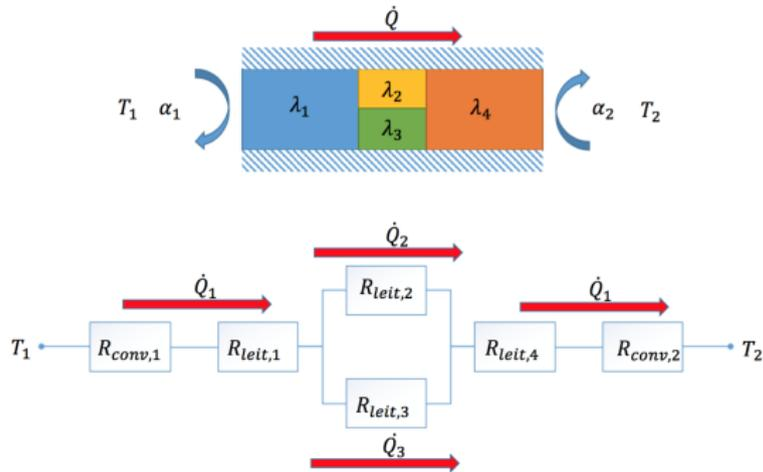
$$R_{\text{tot}} = R_{\text{conv},1} + R_{\text{leit},1} + \frac{R_{\text{leit},2} \cdot R_{\text{leit},3}}{R_{\text{leit},2} + R_{\text{leit},3}} + R_{\text{leit},4} + R_{\text{conv},2}$$
