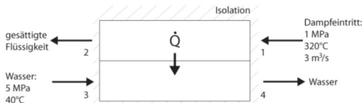
Abb. 2: Wärmetauscher zur Erwärmung von Speisewasser
