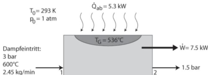
Abb. 3: dampfbetriebene Wärmekraftmaschine mit Abwärmennutzung
