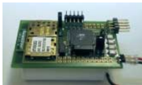
Abbildung 3: Bluetooth Node Prototyp mit Bluetooth Module, Microcontroller, und Batterie
