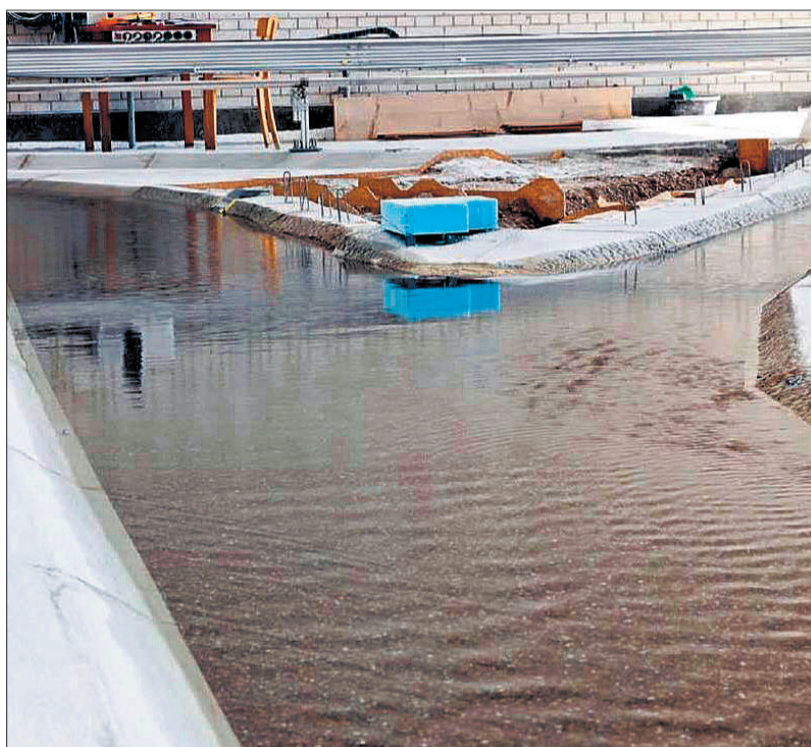
Projektbearbeiter Peter Seitz und seine Forscherkollegin Jill Lucas beim Modell des Reusszopfs in einer Halle der ETH Zürich; unten das Modell in geflutetem Zustand. Links auf den Bildern ist die Nachbildung des Flussbetts der Reuss, rechts dasjenige der Kleinen Emme zu sehen.
