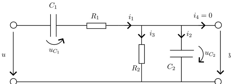
mit  $R_1 = R_2 = 1M\Omega$ ,  $C_1 = C_2 = 1\mu F$
