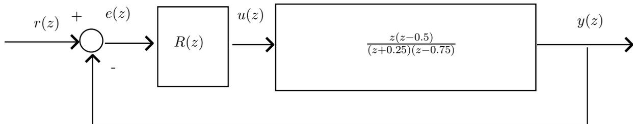
1. Bestimmen Sie  $R(z)$  so dass die Gesamtübertragungsfunktion  $G_{tot}(z) = \frac{y(z)}{r(z)} = \frac{1}{z^2}$ .
