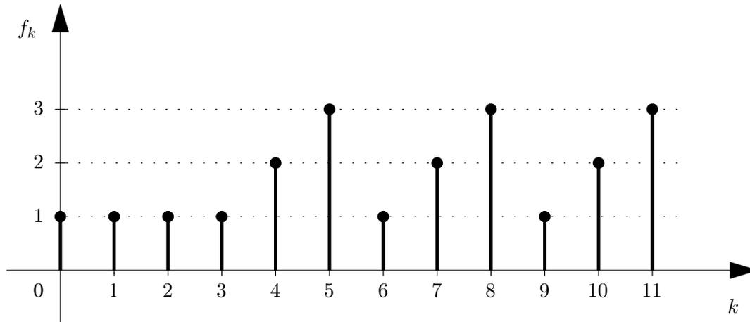
Das Signal hat einen Wert von 1 bis zum Abtastpunkt 3. Danach verläuft es periodisch mit einer Periode von 3.
