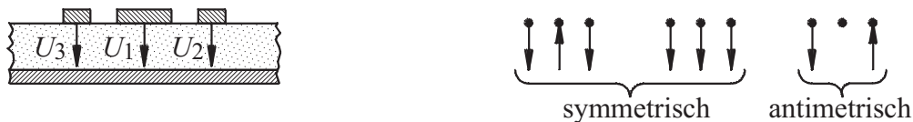
Figur 12.8 Spannungsverteilung der Eigenwerte für die gekoppelte Mikrostreifenleitung.
