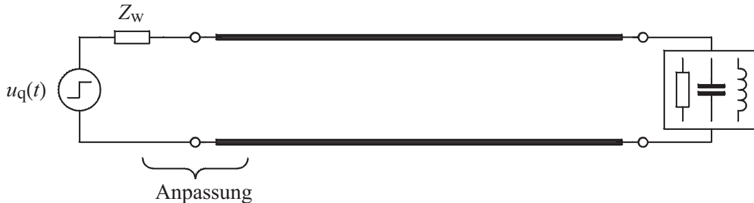
Figur 11.17 Verlustfreie Leitung mit eingangsseitiger Anpassung und reaktiv-resistiver Last
